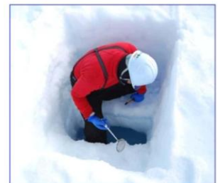
左: 海水上の氷板を手作業で割る。上: 1.5mの積雪を掘って海水を出しドリリングを行う。
