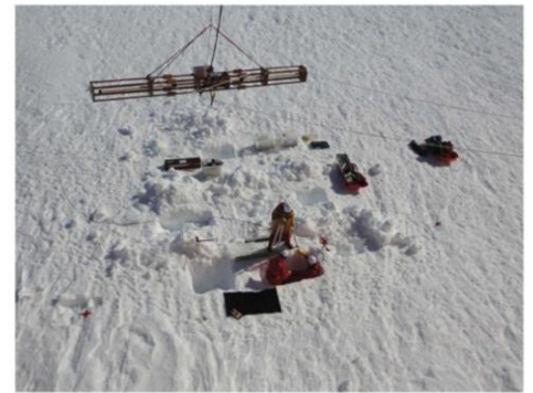
電磁誘導型氷厚センサと海水上でのドリリング作業。
